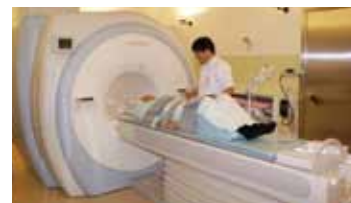
大口径型静音化機能付 3テスラMRI装置
